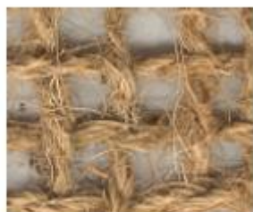
Reti geotessili in fibra di cocco (protezione dall'erosione)
